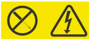
Figure 3-1. Étiquette indiquant un risque de décharge électrique
